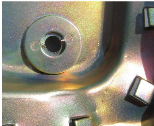
Loch-Verstärkungsscheibe links originale Version, rechts neue mit zu großem Lochdurchmesser
