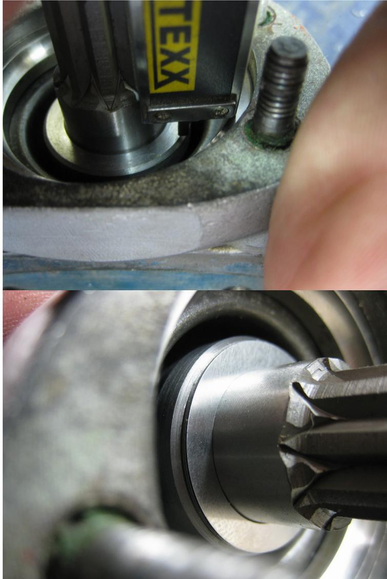
Dann montiert man den Innenring des QB20, den zweiten Außenring und den Deckel mit Dichtung (nötige Stärke der Dichtung und eventuellen Verzug des Deckels beachten!). Die Federscheibe nicht vergessen! Danach folgt der Mitnehmer, welcher mit dem Keilstift gespannt wird. Ob alles paßt, zeigt eine erneute Messung.
