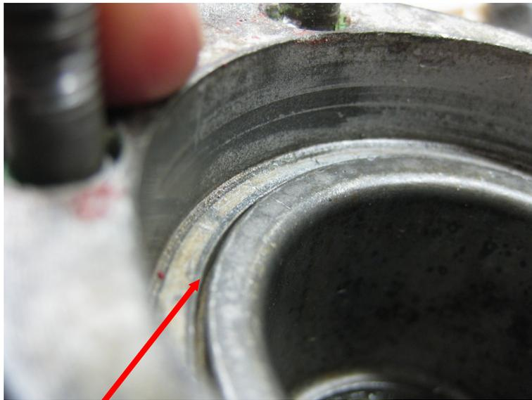
Deshalb muß die Hülse leicht nach gebördelt werden. Am einfachsten geht das mit einem weichem Metall-Hammer (Aluhammer) und einer ebenen Fläche. Gebördelt wird die Seite, die zum NA9404 Lager zeigt. Öfters mal die Passung prüfen, dann kann nichts schief gehen.
