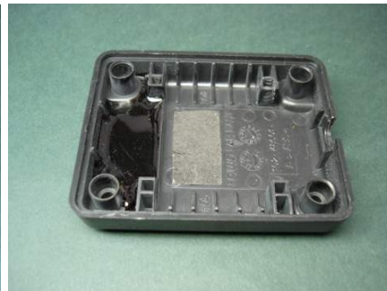
Bild 1.2 und 1.3: Stecker abgesägt und Öffnung vergossen
