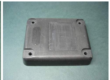
Bild 1.2 und 1.3: Stecker abgesägt und Öffnung vergossen
