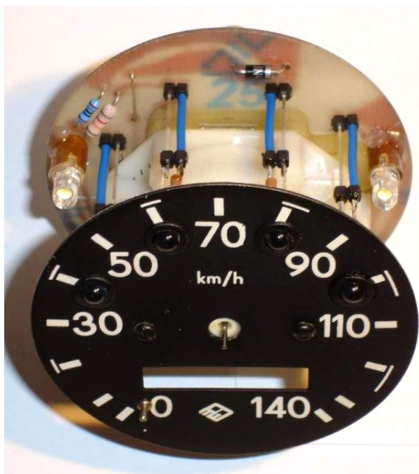
Bild 3.4: so wird die Einheit in das Gehäuse gesetzt und zum „Eichen“ an der TS montiert
