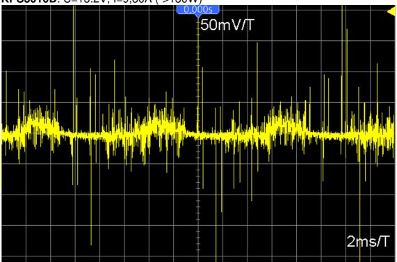
Aus den Oszillogrammen ist ersichtlich, dass das **KPS3010D** auch bei niedriger entnommener Leistung gewaltige Bursts bis zu 200mVpp produziert. Bei 10A Ausgangsstrom sind es schon bis zu 500mVpp. Für die Messung bei voller Leistung (30V, 10A -> 300W) fehlte leider eine geeignete Last. Es ist zu vermuten, dass die Störspitzen weiter anwachsen.
