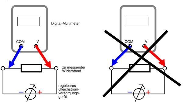
Es ist darauf zu achten, dass die Messspitzen des Spannungsmesskabels unmittelbar am Widerstand aufgesetzt werden. Nur so ist gewährleistet, dass nicht zusätzliche Spannungsabfälle über die Stromanschlusskabel oder die Kontaktierung mit erfasst werden.
