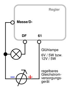
Die abgebildete Test-Schaltung kann sowohl für 6-V- als auch 12-V-Analog-Regler verwendet werden.
