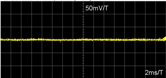
Bei U und I=0 sowie auch bei kurzgeschlossemem 1:10-Oszi-Tastkopf ändert sich an der Darstellung nichts, so dass das sichtbare Rauschen eher seine Ursache im Y-Verstärker des Oszis und nicht in der Qualität der Ausgangsspannung hat.
